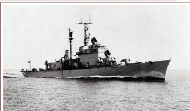
Mar Mediterraneo, febbraio 1964 - Nave Doria in navigazione durante le prove di macchina a tutta forza. La nuova unità è dotata di una rampa binata lanciamissili "Terrier", ha un dislocamento di 6500 tonne e può raggiungere la velocità di 31 nodi.
