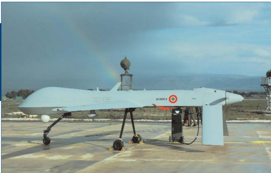
sopra e nelle prossime pagine: Predator, sistema di ricognizione e sorveglianza a largo raggio per operazioni di sorveglianza, impiega un velivolo comandato a distanza. Le immagini possono essere inviate alla stazione di controllo in tempo reale. Il predator è utilizzato in Iraq dalla Italian Joint Task Force
