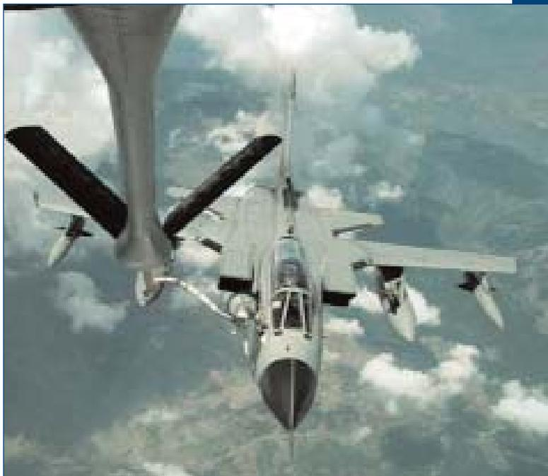
operazione di rifornimento in volo
