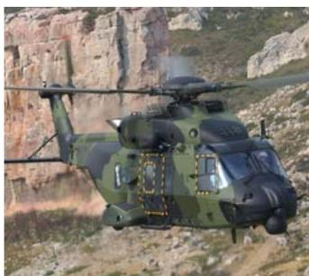
L'NH-90 è un elicottero bimotore quadripala di classe media, in grado di trasportare 14 militari equipaggiati, ovvero un carico di 2,5 T. Può essere equipaggiato con 2 mitragliatrici calibro 7,62 e dispone di un sistema integrato di guerra elettronica in grado di rilevare/identificare minacce laser, missile e radar e reagire mediante il lancio di chaff&flares. L'elicottero si configura quale assetto di trasporto tattico nell'ambito di unità di volo combinata.
