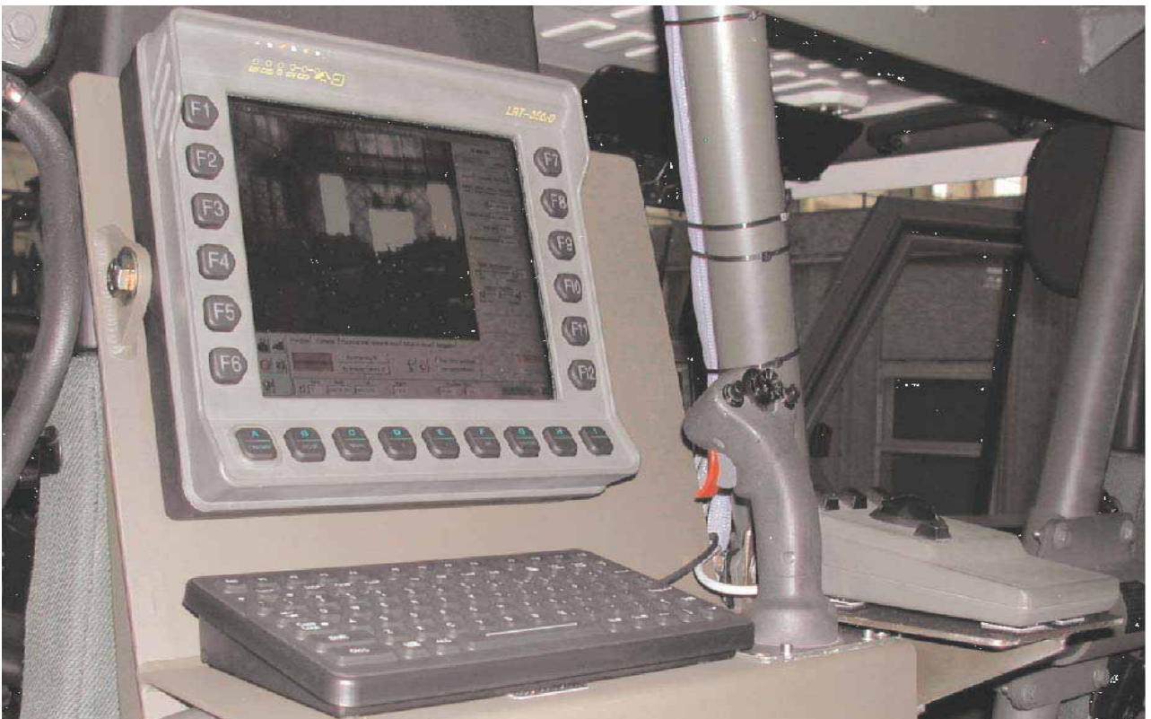
FIG. 90 - LA «DIGITALIZZAZIONE». SISTEMA INTEGRATO DI COMANDO E CONTROLLO E NAVIGAZIONE (SICCONA) TABLE 90 - DIGITISATION. INTEGRATED COMMAND, CONTROL, AND NAVIGATION SYSTEM (SICCONA)
