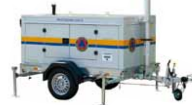
Unità di illuminazione mobile su carrello omologato per traino veloce stradale
